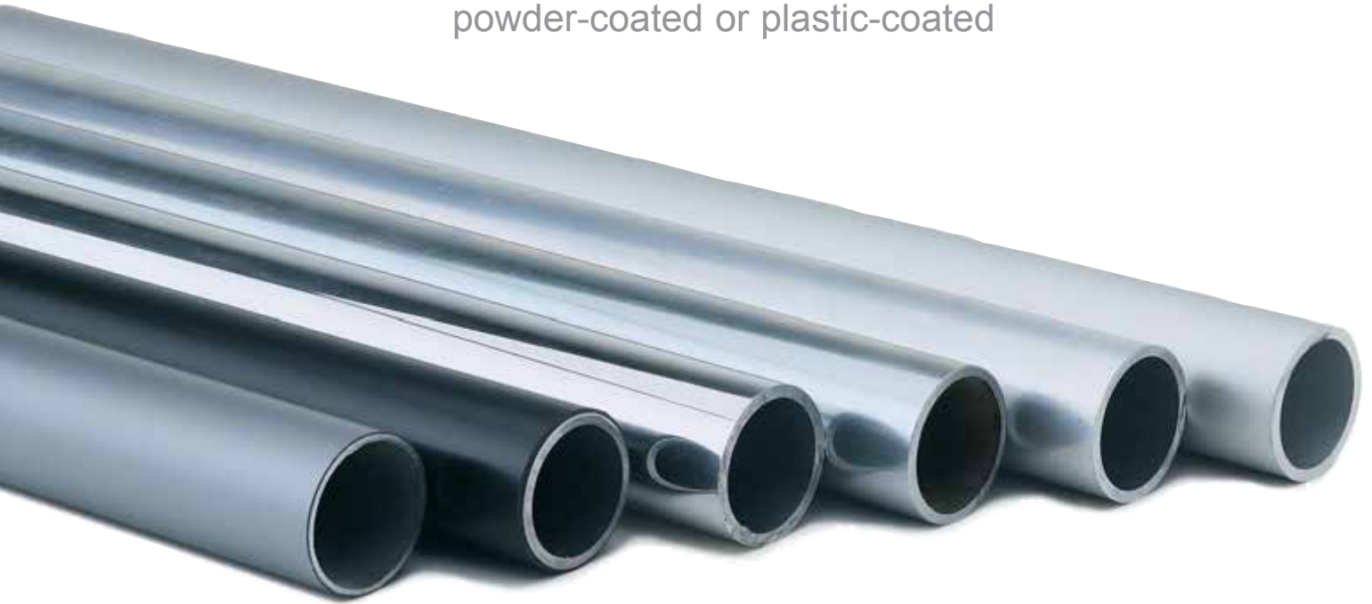
Foto oben v. li. n. re.: Stahlrohr - kunststoffummantelt silber RAL 9006, Stahlrohr - kunststoffummantelt schwarz RAL 9005, Aluminiumrohr poliert, Stahlrohr galvanisch verzinkt, Aluminiumrohr pressblank, Aluminiumrohr eloxiert
