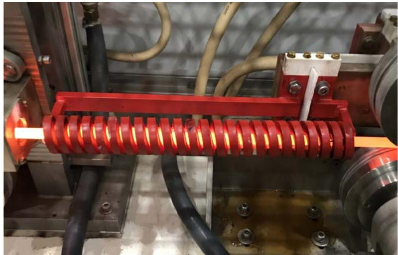
Durch die einfache Einstellbarkeit der Prozessparameter einer Induktionsanlage können vielfältige Prozesse realisiert werden. Bei niedrigen Temperaturen werden Drähte oder Bänder getrocknet. Bei höheren Temperaturen werden Drähte oder Bänder beschichtet oder die Werkstoffeigenschaften gezielt eingestellt. Dabei kann je nach Anforderung eine Randschichtwärmerung oder eine Durcherwärmerung der Bauteile realisiert werden.
