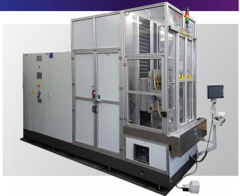
Das Basispaket umfasst neben der frei programmierbaren Siemens-Steuerung zwei Rückkühlanlagen für Kühlwasser und Emulsion sowie den notwendigen Umrichter zur Leistungserzeugung (inklusive Trafo bzw. Schwingkreis).
