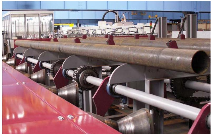
Die kombinierte Härte- und Anlassenanlage für Rohre kann je nach den vorhandenen Platzverhältnissen als Inline-Anlage oder in U-Form aufgebaut werden. Verschiedene Spulensätze, die auf den Rohrdurchmesser angepasst sind, erlauben ein breites Spektrum an Rohrdurchmessern.
