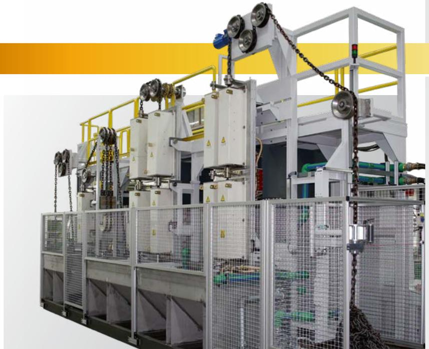
Härtetemperaturen bis 1.000°C, beliebig einstellbare Anlasstemperaturen und die Möglichkeit zum partiellen Anlassen ermöglichen dem Kunden eine maximale Flexibilität mit nur einer Anlage.
