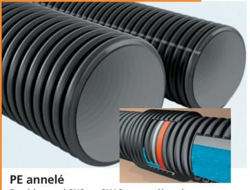
Double paroi SN8 ou SN16, en matière vierge ou recyclée. Longueur 6 m. Ø 160 à 1200 mm.
